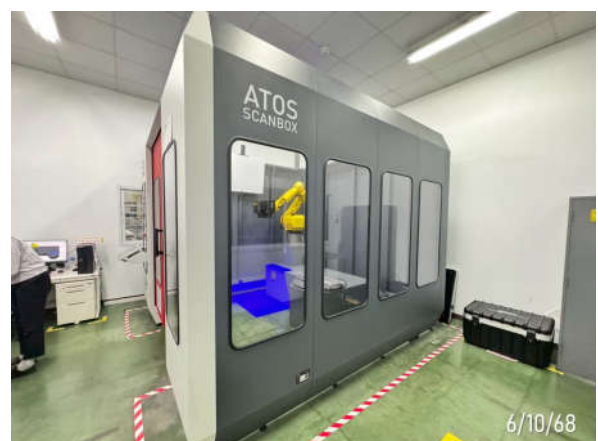
เครื่องตรวจสอบชิ้นงาน (ATOS Scanbox 5120, GOM)
